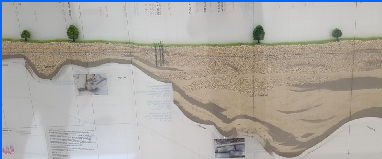
Slika 5.162 Dio hidrogeološkog profila zagrebačkog i samoborsko-zaprešićkog vodonosnika, izvor: Kristijan Posavec (2018), RGNF
